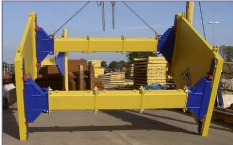
Zum Umschwenken der RS-Box wird die Kette in die oberen Ösen einer RS-Abstützung eingehängt und durch einseitiges Anheben der Box um 90° gedreht bis die untere Stütze auf dem Untergrund flächig aufliegt. Die Kette am RS umhängen, es sind die zum Plattenkopf weisenden Ziehösen zu verwenden.
